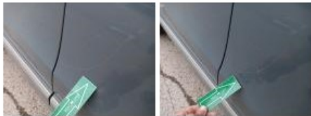
Puerta Tras Dr, Rayado, Reparar + Pintar
